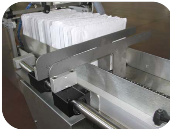
0.2 Particolare del punto di carico del magazzino/ Stacker detail
